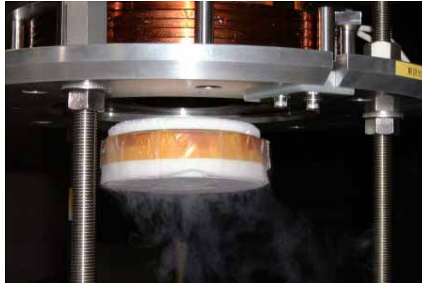
高温超伝導コイルの磁気浮上制御実験
