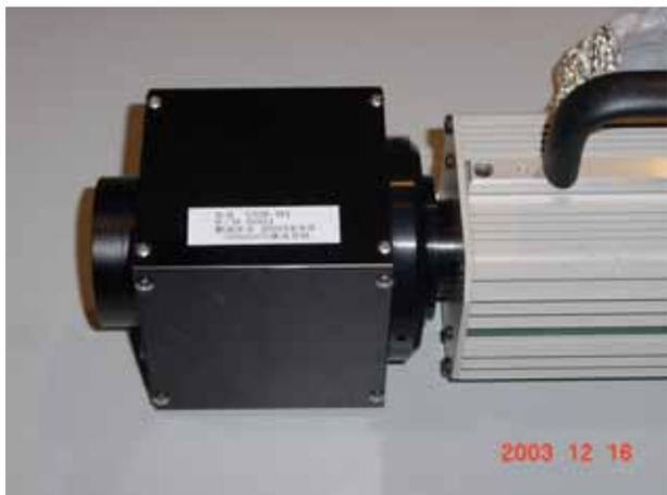
図 1 3 超音波モーターを利用した強磁場中で動作可能なレンズ
