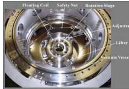
図 19 Mini-RT 装置の真空容器の内部
