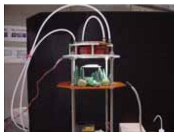
図 2 1 小型の磁気浮上制御技術開発システム
